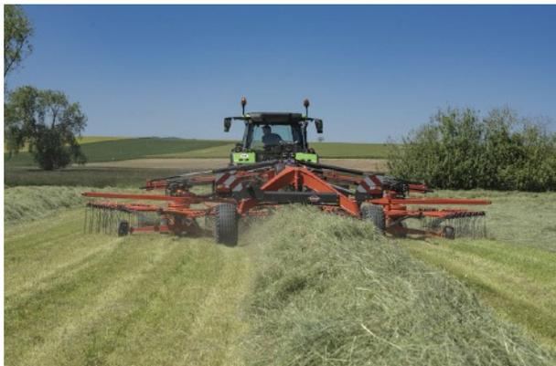
Con il modello GA 9531+, dotato di 15 bracci per rotore (4m di diametro), l'operatore può raggruppare due andane di paglia a seguire il lavoro di mietitrebbie dotate di larghezze di taglio fino a 7,50 m.
