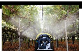
d'aria ad alta velocità (180 m/s) generato da un ventilatore centrifugo, viene incanalato in una strozzatura dove avviene l'erogazione del prodotto chimico a bassissima pressione. Grazie a questo sistema non sono presenti ugelli come nella macchina tradizionale.
