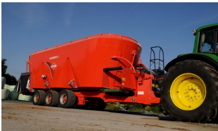
Le gamme **Profile** con 1, 2 coclee verticali ed **Euromix** con 3 coclee verticali sono disponibili in diverse capacità che vanno da 4 a 45 metri cubi. Dotate di serie di dispositivo di pesatura, entrambe le gamme realizzano delle razioni perfettamente miscelate, rispettando le necessità di ruminazione della mandria a garanzia di un'alimentazione di massima qualità.
