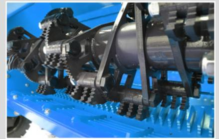
Rotore XP con supporti dentati, coltelli e controcoltelli dentati
